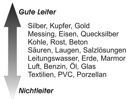
Abb. 4 Elektrische Leiter und Nichtleiter
