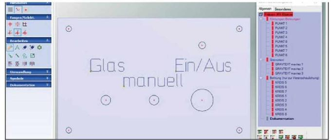
Abbildung 2: Die Aluminiumabdeckung als CAD, gezeichnet in NCCAD 9 (fertig zur automatisierten Fertigung)
