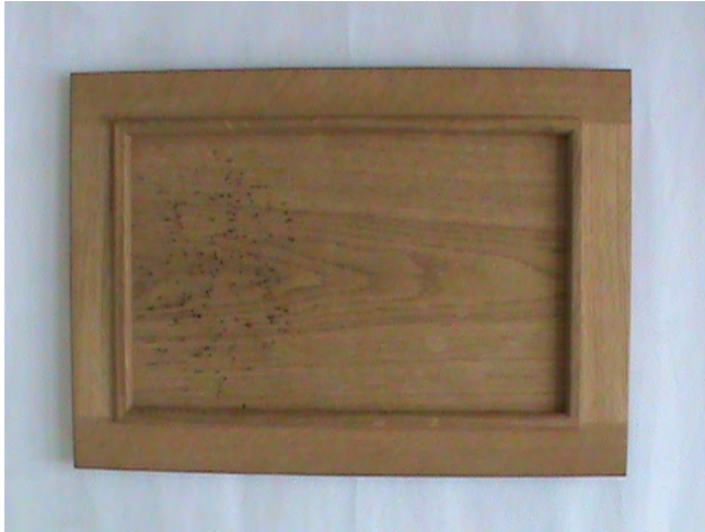
Abbildung 5: Rahmentür aus Eiche mit sechs Fehlern zur Durchführung des Fachwissenstests
