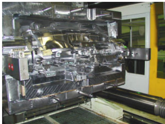
Abbildung 7: Formhälfte mit ausgefahrenen Aushebesegmenten und Auswerfern
