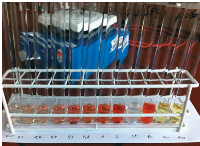
Abb. 3. Reagenzgläser nach Wöhlk-Malfatti-Probe: Zahlen sind Konzentrationsangaben in Prozent der Maltose-Referenzlösungen; St = Stärkelösung, Pr = Produktlösung; sowie Glucose und Fructose, jeweils w = 1\%
