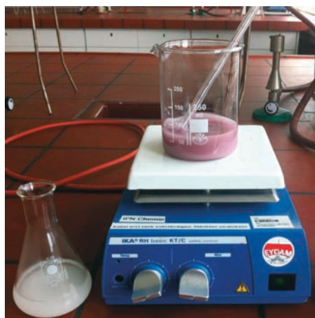
Abb. 1. Stärkelösung ( w = 2\% ), links unten ohne Zusätze, auf der Heizplatte bei 37\text{ }^{\circ}\text{C} mit einem Tropfen Iodlösung ( c = 0,05\text{ mol/L} ) und ca. 1\text{ mL} Speichel
