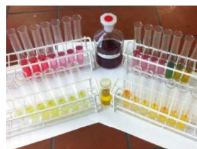
Abb. 2: Jeweils zwei Verdünnungsreihen mit pH 1-7 (links) und pH 8-14 (rechts) für Rotkohlindikator (hinten) und Curcuma-Lösung (vorne)
