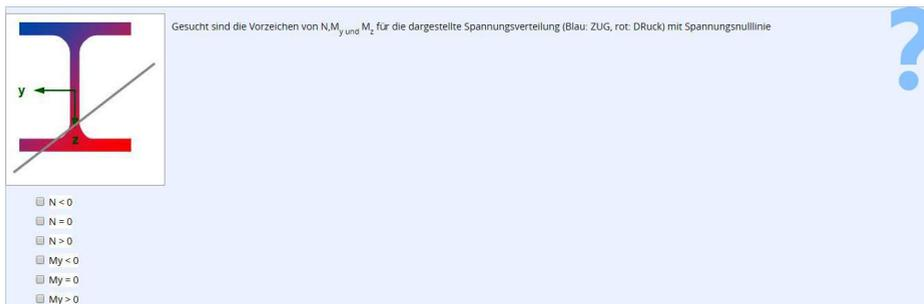
Gesucht sind die Vorzeichen von  $N$ ,  $M_y$  und  $M_z$  für die dargestellte Spannungsverteilung (Blau: ZUG, rot: DRUCK) mit Spannungsnulllinie
