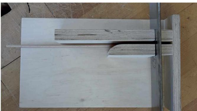
Abbildung 13: Draufsicht der angepassten Gehrungslade mit Feinsäge
