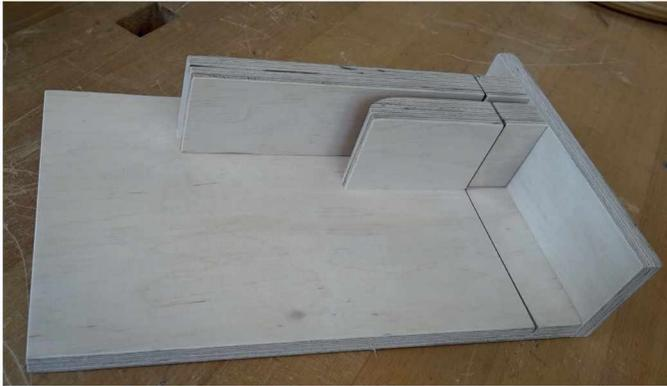
Abbildung 12: Angepasste Gehrungslade mit Sägeschnitt
