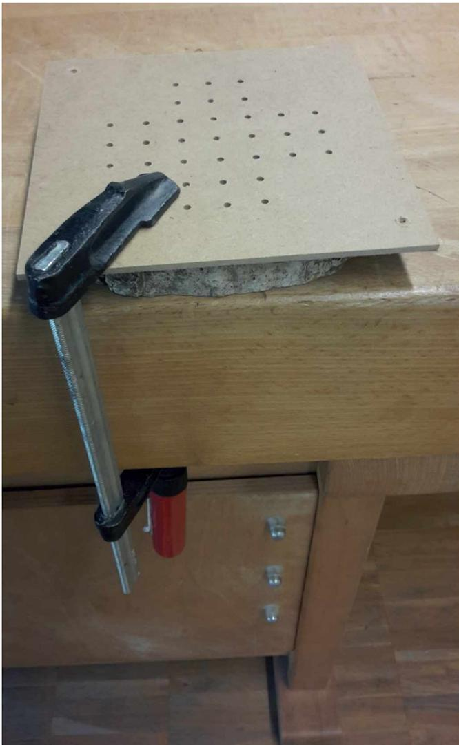
Abbildung 5: Schablone mit Schraubzwinge auf Werkbank fixiert
