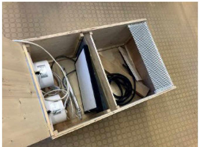
Abbildung 7: Einbau des Lüfters und der Filter
