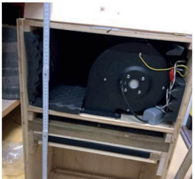
Abbildung 9: Einbau des Akustikschaumstoffs
