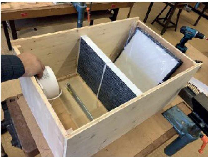
Abbildung 6: Einbau der Filter in das Gehäuse
