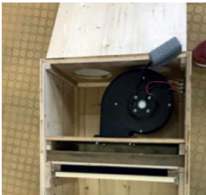
Abbildung 8: Einbau des Radialgebläses
