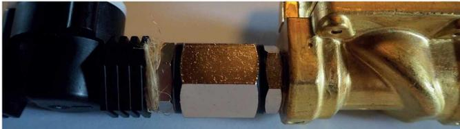
Abbildung 5: Verbindungsstück zwischen Flowmeter und Magnetventil
