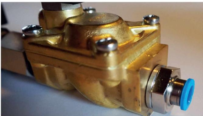
Abbildung 6: Anschluss Steckverbinder Schlauch
