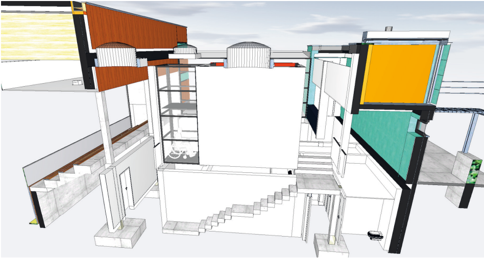
Abbildung 2: Digitales Bauwerkmodell als virtuelle Lern- und Arbeitsumgebung im BIM-Viewer (Quelle: H. Trompeter)
