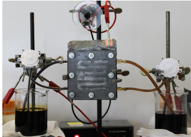
Abb. 6: Aufbau einer PMMA-Redox-Flow-Zelle als Skizze (links) und im Original (rechts)
