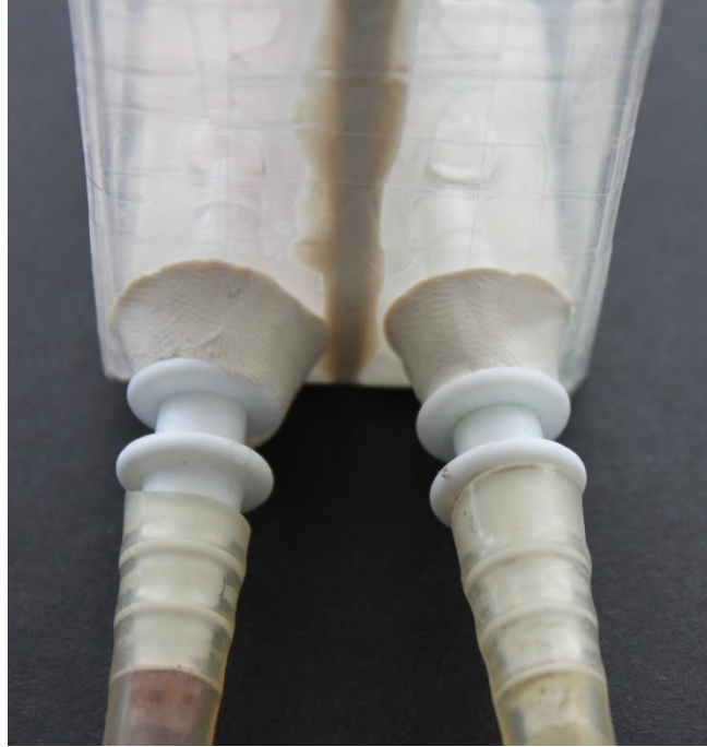
Abb. 10: Dichtung der Ausgänge der TicTac-Dose
