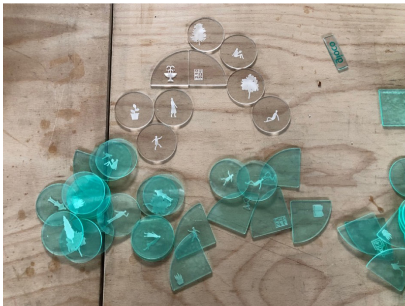
Fig. 5 – Realizzazione prototipo: tessere in plexiglas con icone di forma geometrica e organica scrivibili, per rappresentare le caratteristiche degli spazi (con macchina lasercut presente in Fablab BITZ UNIBZ)
