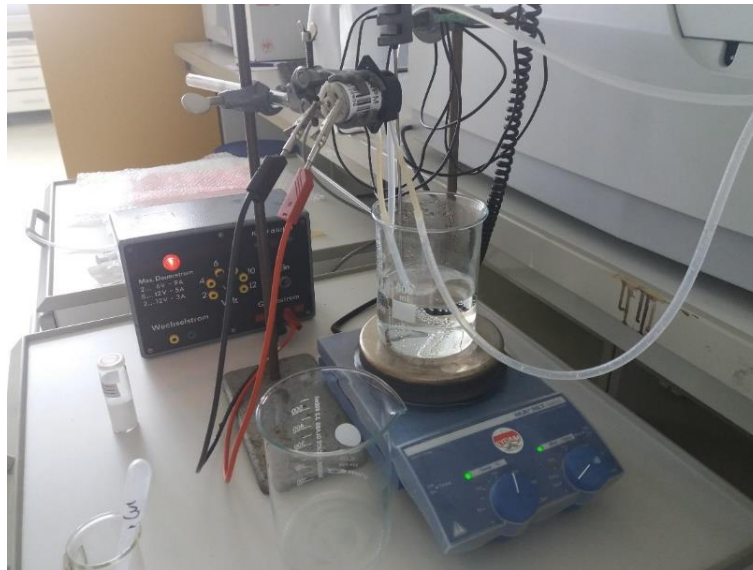
Abbildung 29: Temperierbares Wasserbad mit Schlauchpumpe und Stromversorgung
