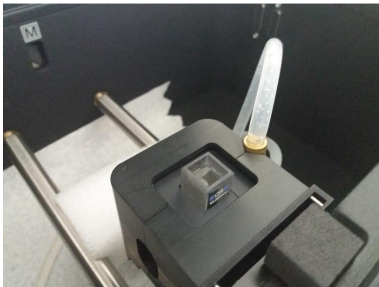
Abbildung 30: Temperierbarer Küvettenhalter im Innenraum des UV-Vis-Spektrometers
