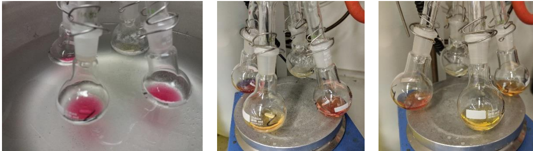
Abbildung 26: Fearon-Test unter Sauerstoffausschluss, nach 10 Min., 16 Std., 30 Std. (siehe Text)
