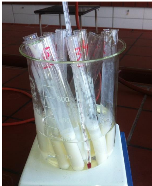
Abbildung 105: Wöhlk-Proben im Wasserbad (Beginn)
