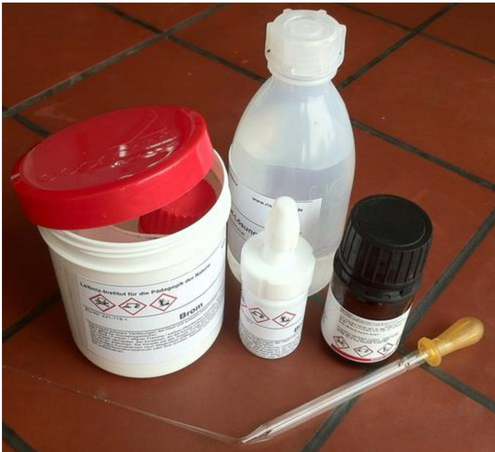
Abb. 1: Links: selbstgebastelte Brom-Box aus einer apothekenüblichen Salbendose und Innengefäß, das auf Aktivkohle steht; Hinten: Natriumthiosulfatlösung, davor PTFE-Gefäß und kunststoffummantelte Glasflasche, beide bruchsicher, zum Aufbewahren von elementarem Brom; Davor: abgeknickte Pasteur-Pipette (=“Bromfüller”). (Foto: Ruppertsberg)
