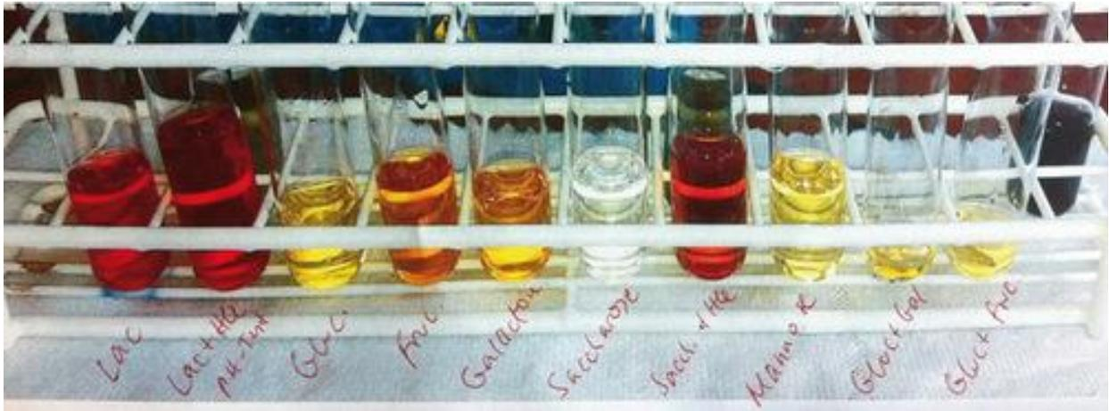
**Abb. 7:** Wöhlk-Probe mit Lösungen von verschiedenen reinen Zuckern und Zucker-Gemischen, von links nach rechts: 1. Lactose, 2. Lactose mit HCl-Zugabe, nach 20 Min. neutralisiert, 3. Glucose, 4. Fructose, 5. Galactose, 6. Saccharose, 7. Saccharose mit HCl, nach 20 Min. neutralisiert, 8. Mannose, 9. Glucose und Galactose, 10. Glucose und Fructose.
