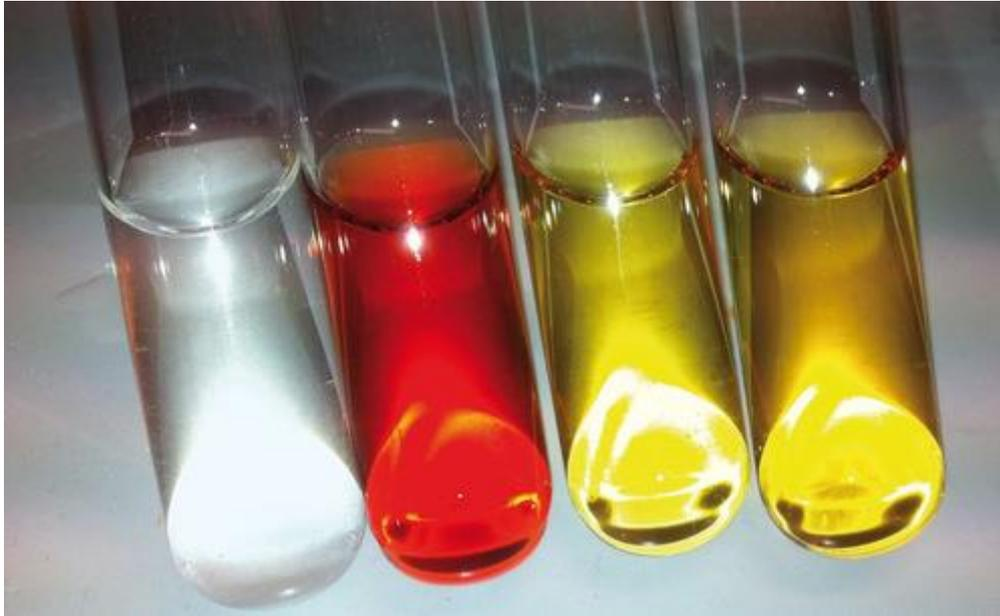
**Abb. 1:** Die Wöhlk-Probe funktioniert mit Lactose und Maltose, nicht aber mit Schleimsäure (ganz links) oder mit den Monomeren Glucose (mitte-rechts) und Galactose (ganz rechts).
