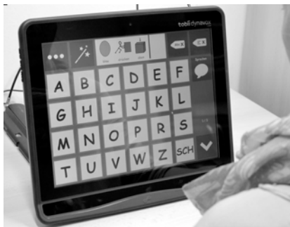
Abb. 2: Augensteuerung Tobii Dynavox (TU Dortmund Studylab)
