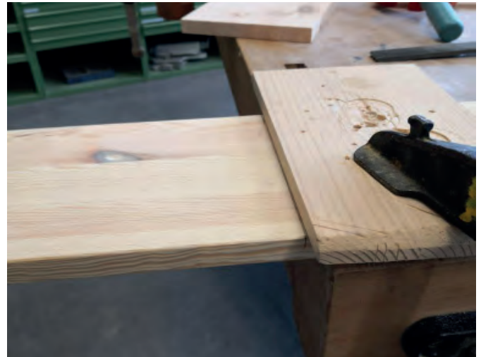
Abbildung 1: Sägen mit einem Führungsbrett
