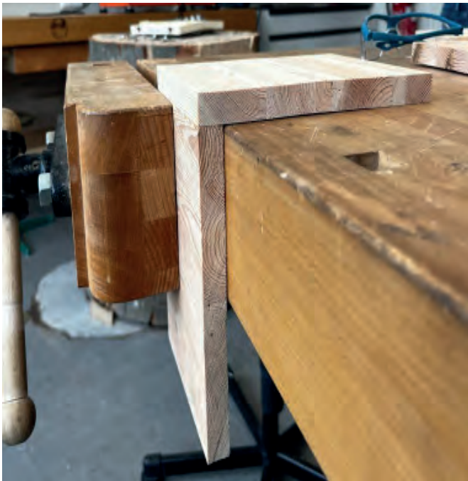
Abbildung 3: Einspannen des Holzes zum Verbinden der Seiten
