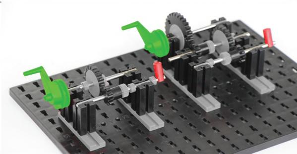
Auf der linken Seite wird **dreimal negativ** an dem Operator  $[-2]$  gekurbelt. Die Ausgabe sind sechs Umdrehungen in positiver Richtung bzw. **+6**.
