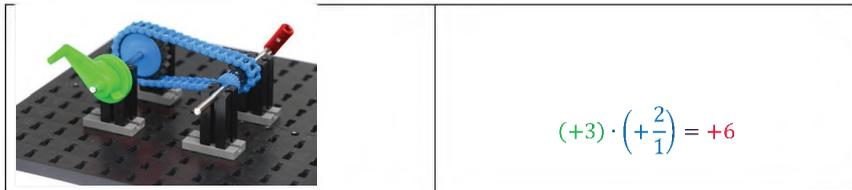
Man könnte ebensogut in mathematisch negativer Richtung kurbeln, dann dreht auch die hintere Achse sechsmal in negativem Drehsinn:  $(-3) \cdot \left(+\frac{2}{1}\right) = -6$ .
