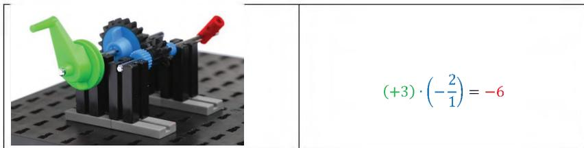
Der Operator lautet „ $\cdot \left(-\frac{20}{10}\right)$ “ bzw. „ $\cdot \left(-\frac{2}{1}\right)$ “. Das Minus bedeutet, dass die Beziehung der beiden Zahnräder gegensinnig oder negativ ist. Eine Verbindung über eine Kette ermöglicht eine positive Beziehung zwischen den Rädern, lässt die Räder also gleichsinnig laufen.
