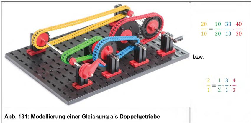
Abb. 131: Modellierung einer Gleichung als Doppelgetriebe
