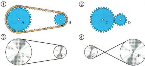
Bewirken alle vier Getriebe das gleiche? Wie groß sind die Übersetzungen der vier Getriebe? Das große Rad ist in allen Fällen doppelt so groß wie das kleine.
