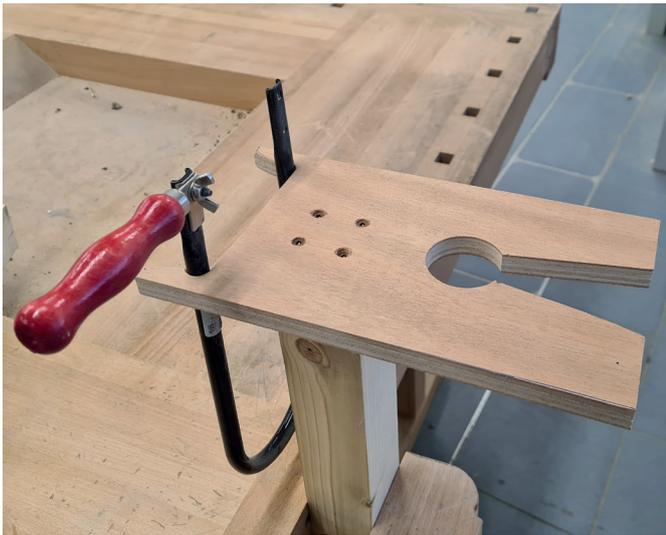
Abbildung 3: Sägebock „Sehbo“ mit Einspannhilfe
