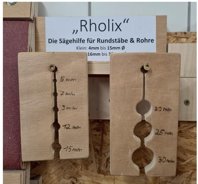
Abbildung 1: Die Sägehilfe Rholix für Rundstäbe
