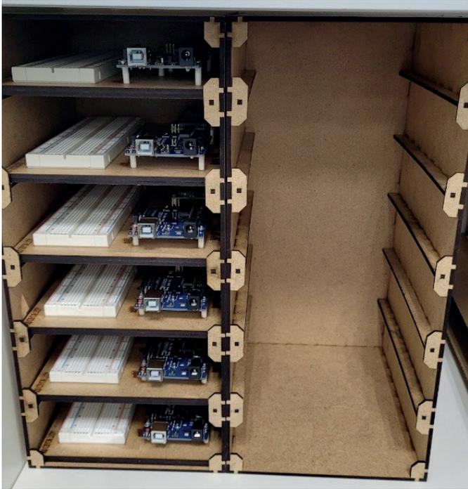
Abbildung 2: Lagerungssystem für Mikrocontroller-Arbeitsbretter
