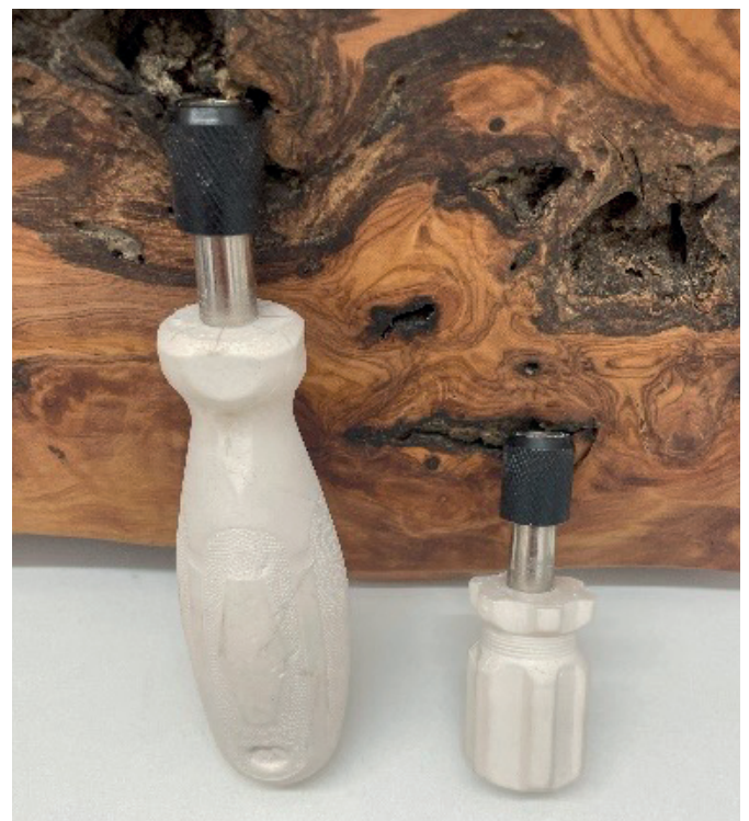
Abbildung 9: Die fertigen Schraubendreher mit den eingelassenen und verklebten Bithaltern.
