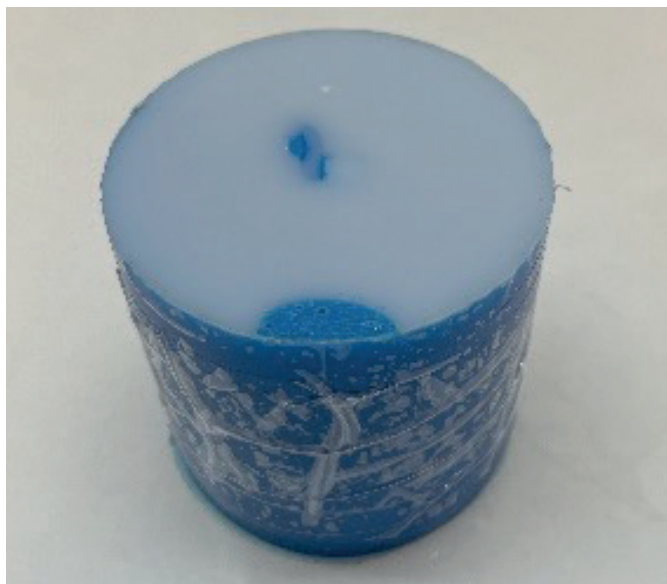
Abbildung 5: Die Silikonform wurde vor dem Gießen mit Tesafilm seitlich geschlossen. Hier ist das Harz bereits ausgehärtet
