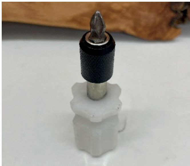
Abbildung 8: Die Bithalter werden in die dafür gebohrten Löcher eingelassen und verklebt.
