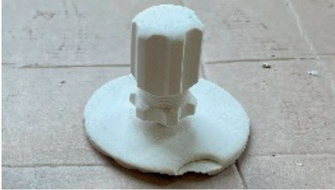
Abbildung 7: Nach dem Entschalen müssen die gegossenen Griffe noch nachbearbeitet werden.
