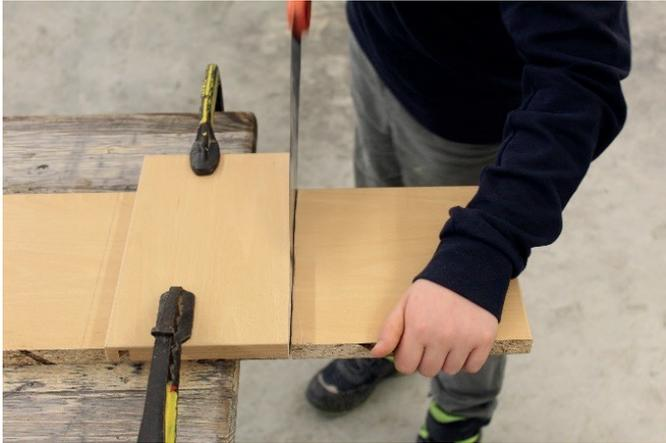
Abbildung 3: Geführtes Sägen
