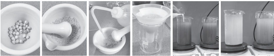
Abb. 5: Ablauf des Modellexperiments zur Wasseraufreinigung mit Moringa-Samen
