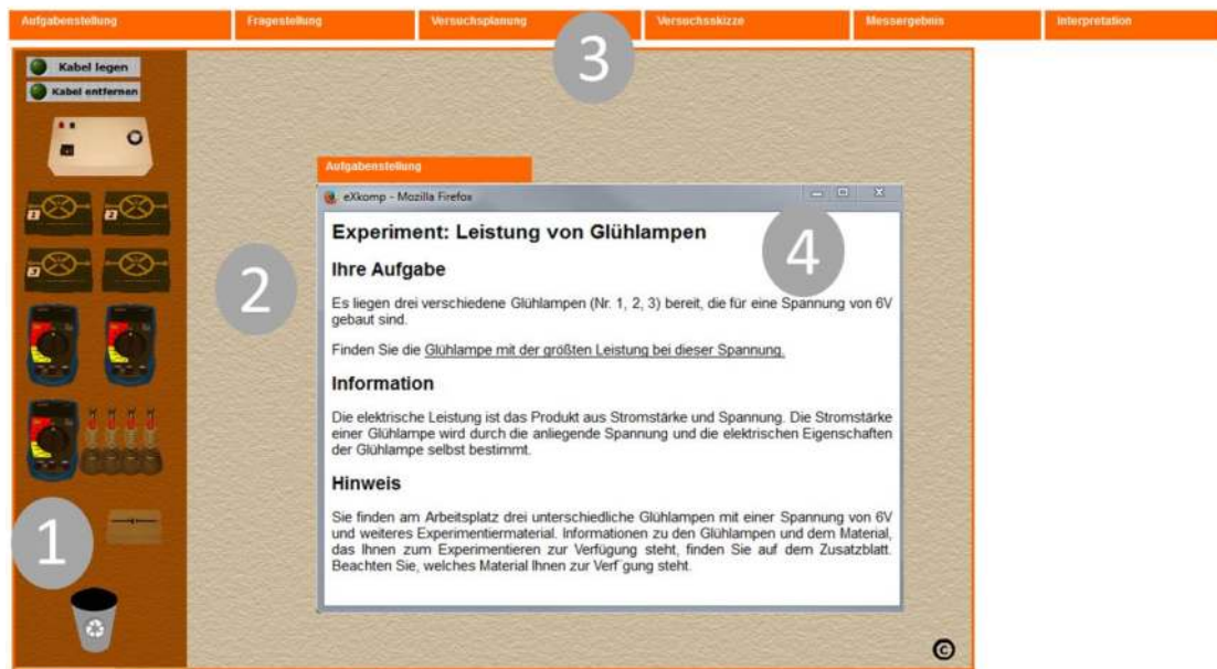
Abbildung 2.5: Aufgabe aus dem eXkomp Projekt (Schreiber et al., 2014); 1: zur Verfügung stehendes Experimentiermaterial; 2: Simulationsfläche; 3: Reiter zum Öffnen von Pop-up Fenstern mit Aufgabenstellung bzw. Möglichkeiten zur Bearbeitung von weiteren Teilaufgaben (z. B. Versuchsskizze anfertigen); 4: geöffnetes Pop-up Fenster mit Aufgabenstellung (hier: „Leistung von Glühlampen bestimmen“); eigener Screenshot)
