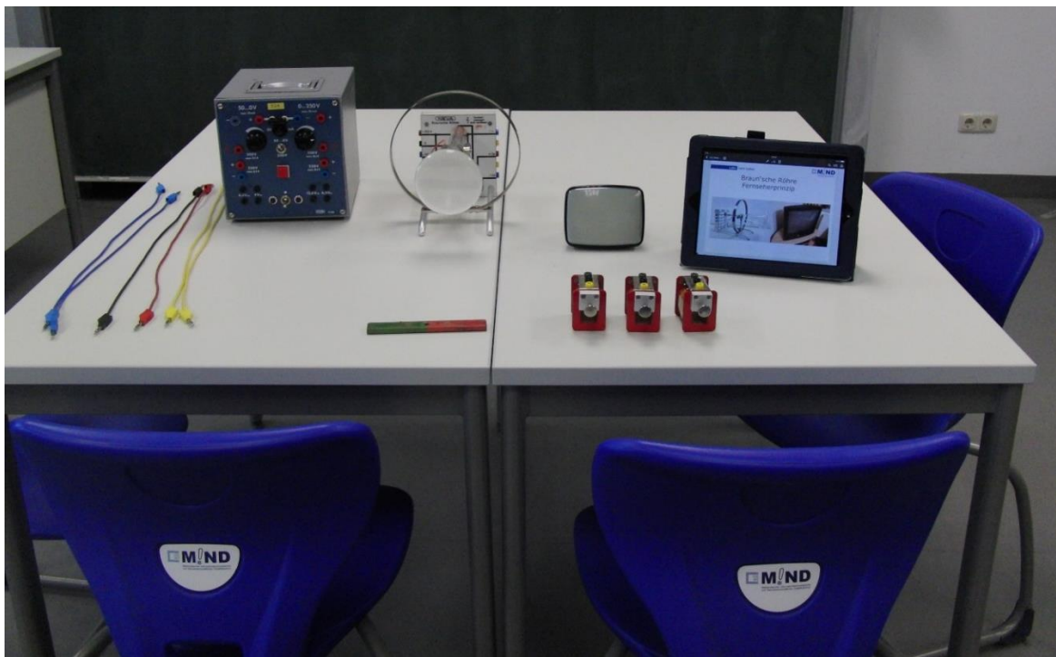
Abbildung 3: Experimentierstation „Braun'sche Röhre“ zum Thema Elektrizitätslehre.
