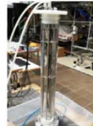
Abbildung 1: Testspeicher zur Materialcharakterisierung (10 Liter Inhalt)
