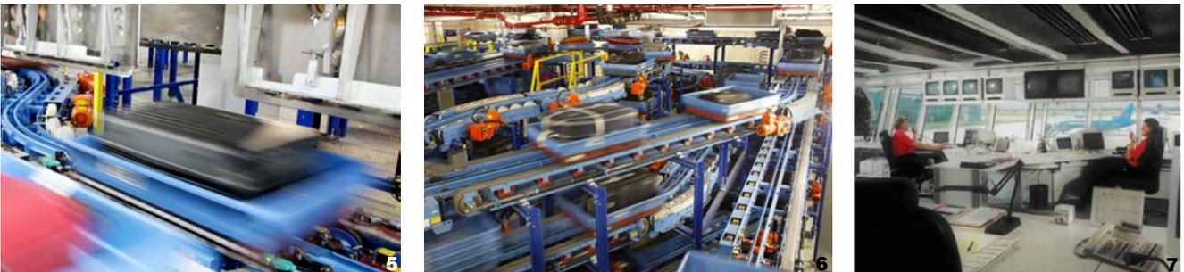
Die Position der Gepäckstücke wird durch Kameras, Sensoren und Lichtschranken mehrmals gescannt und erfasst. So wird sichergestellt, dass kein Gepäckstück verloren geht. Havarien der Transportanlagen werden schnell erfasst und beseitigt.
