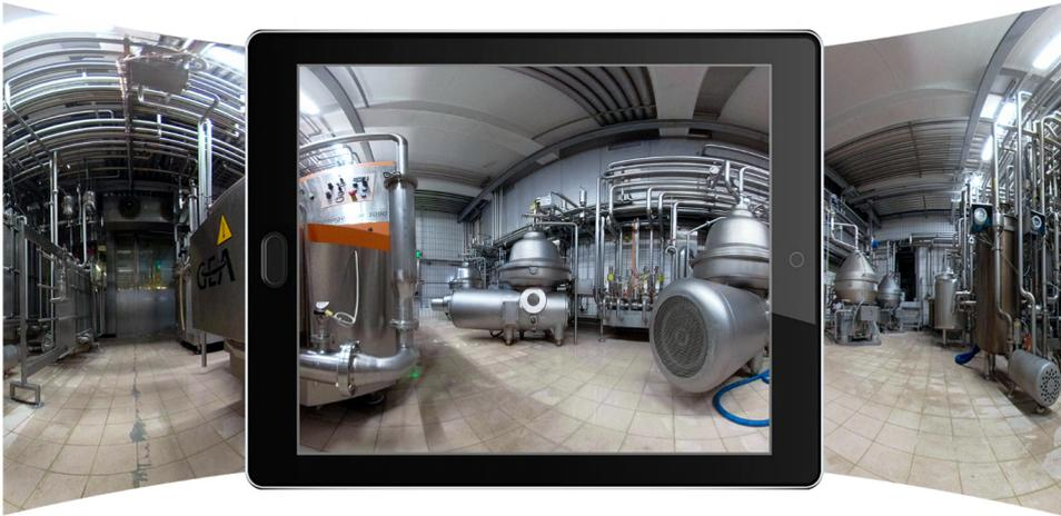
**Abbildung 5:** Beispiel einer virtuellen Tour durch eine Molkerei mit realen Zentrifugen und Homogenisatoren (eigene Darstellung)
