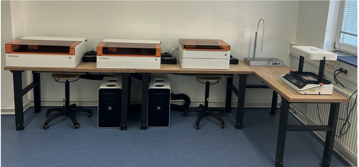
Abbildung 3: Laserschneide- und Tiefziehmaschine
