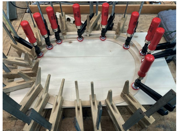
Abbildung 5: Realisierung der Steigung durch Verleimen.
