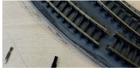
Abbildung 7: Gleisisolierer aus Kunststoff isolieren einzelne Gleisabschnitte
