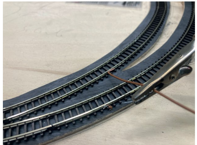
Abbildung 8: Isolierte Abschnitte werden gesondert mit Strom versorgt
